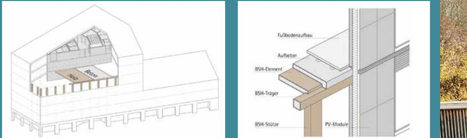
In den sechs Obergeschossen verbinden sich 20 Zentimeter dicke Brettspertholzdecken mit einer zehn Zentimeter dicken Aufbetonung. Die Decken spannen sieben Meter weit und liegen an den Fassaden auf 27 mal 44 Zentimeter starken Brettschichtholzstützen auf.
